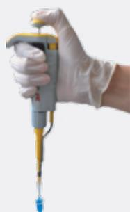
Pedir a los participantes que pipeteen el líquido (agua) con el volumen correspondiente a partir de un vaso de precipitado y que lo descarten en un tubo plástico
